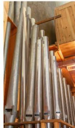
» „Die Orgel leidet unter Windmangel. Es gibt sehr viele Undichtigkeiten, z.B. an den Schwimmerbälgen, dem Hauptbalg, Windkanälen und den Sperrventilen. Im Hauptwerk verschleichen Unmengen Wind unter den vielen Schleifen.“
